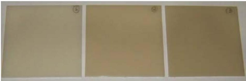
Figura 3.4: Exemplo das placas utilizadas para as medidas de contração [72].
