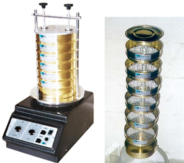
Figuras 3.1 e 3.2: Agitador eletro-magnético (tipo Granutest) e conjunto de peneiras Tyler [64]
