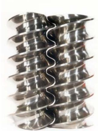
Figura 2.19 Ilustração de parte de um conjunto rosca co-rotacional.
